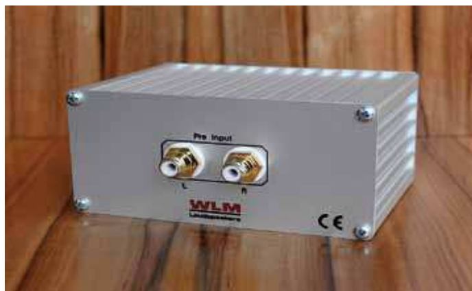
Cut Box, Vorverstärker-Eingang
