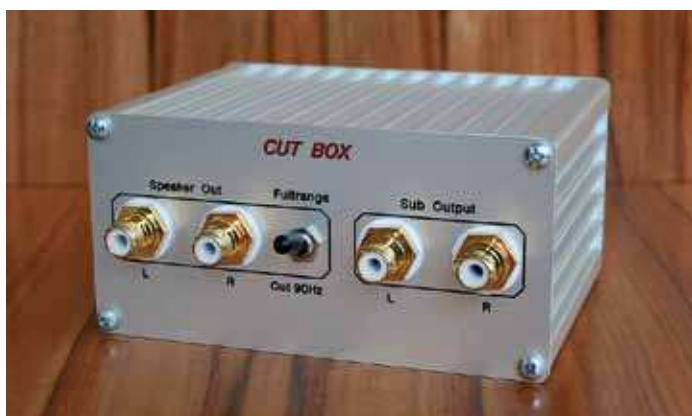
Cut Box: Ausgänge an Endstufe für Lautsprecher und an aktiven Subbass. Umschalter für Fullrange-Betrieb oder Cut-Betrieb bei 90Hz.
