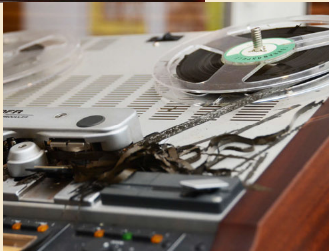
Massiv beschädigtes Bandmaterial
