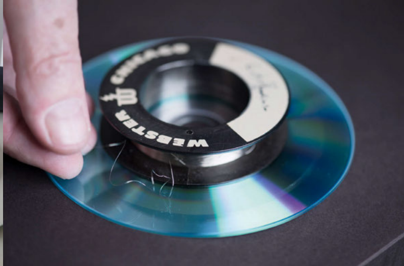
Stahlfaden als Datenträger
