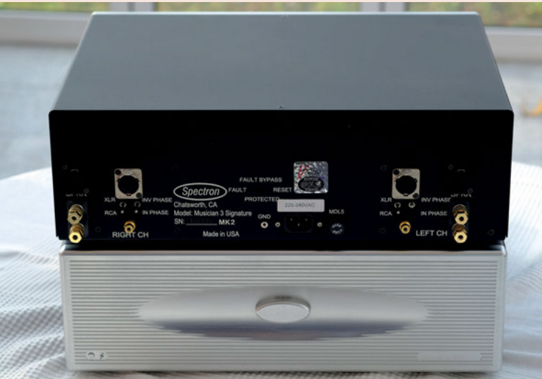
Spectron: Leistung ohne Ende – über 2 kW pro Kanal stehen im Monobetrieb zur Verfügung.
