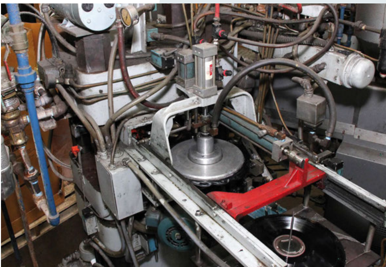
Eine Plattenpresse von United Record Pressing. Courtesy of Rainbo Records/Steve Sheldon.
