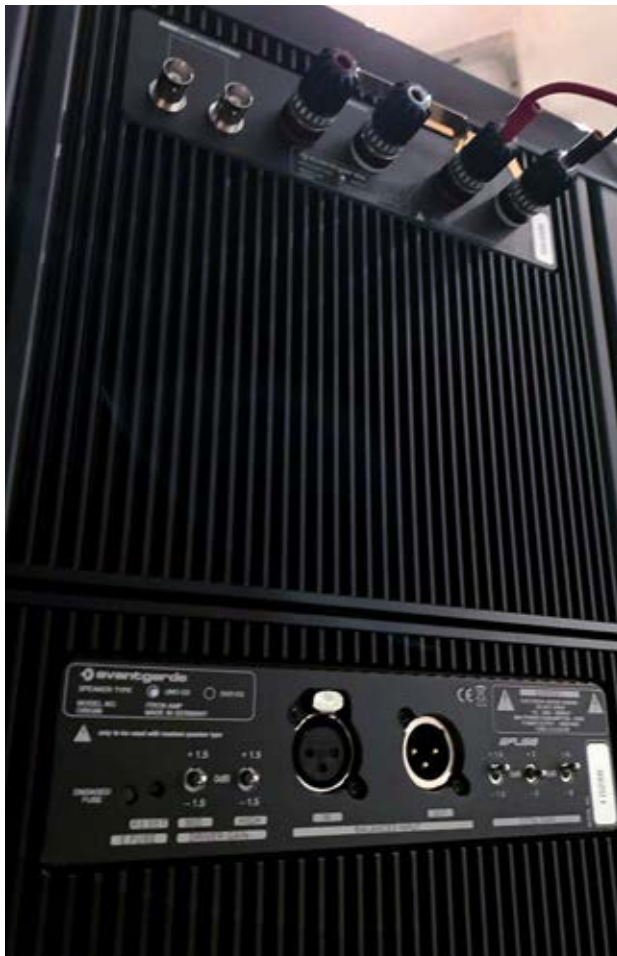
BETRIEBSBEREIT: Rücken der Uno SD beim Vorführmodell von Aug & Ohr. Hier vorbereitet für den Anschluss einer externen Endstufe für Mittel/Hochton. Darunter das iTRON-Verstärkermodul mit fünf Kippschaltern zur Feinabstimmung und symmetrischen XLR-Anschlüssen.
